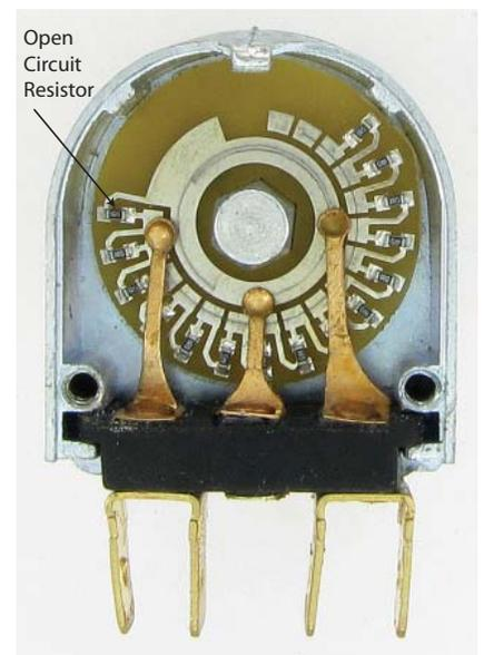
Fig. 4. New rheostat internal
